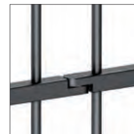
4 Cerniere antiscasso Tutti i traversi delle ante apribili con snodo sono uniti con cerniere antiscasso
