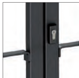
2 Serratura a 3 punti di chiusura con puntali superiori e inferiori che hanno 25 mm di escursione. La serratura è caratterizzata anche da un catenaccio di chiusura centrale a baionetta.
