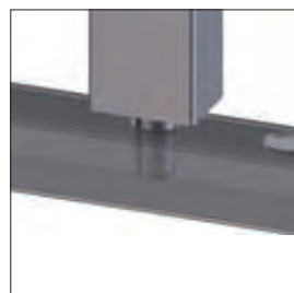
3 Puntali di chiusura antitaglio Puntali di chiusura superiori ed inferiori in acciaio temprato (antitaglio) aventi diametro 14 mm.
